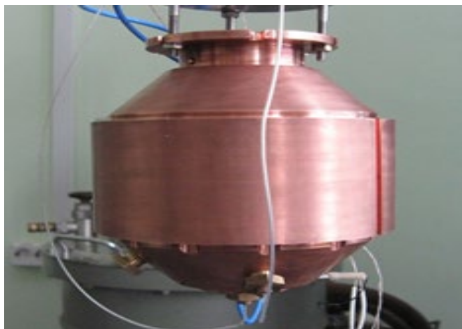
Установка для измерения акустическим методом термодинамической температуры в диапазоне от 79 до 273,16 К
