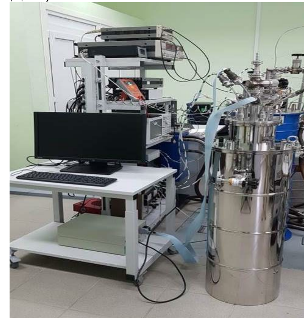
Установка для измерения акустическим методом термодинамической температуры в диапазоне от 4,2 до 80 К
