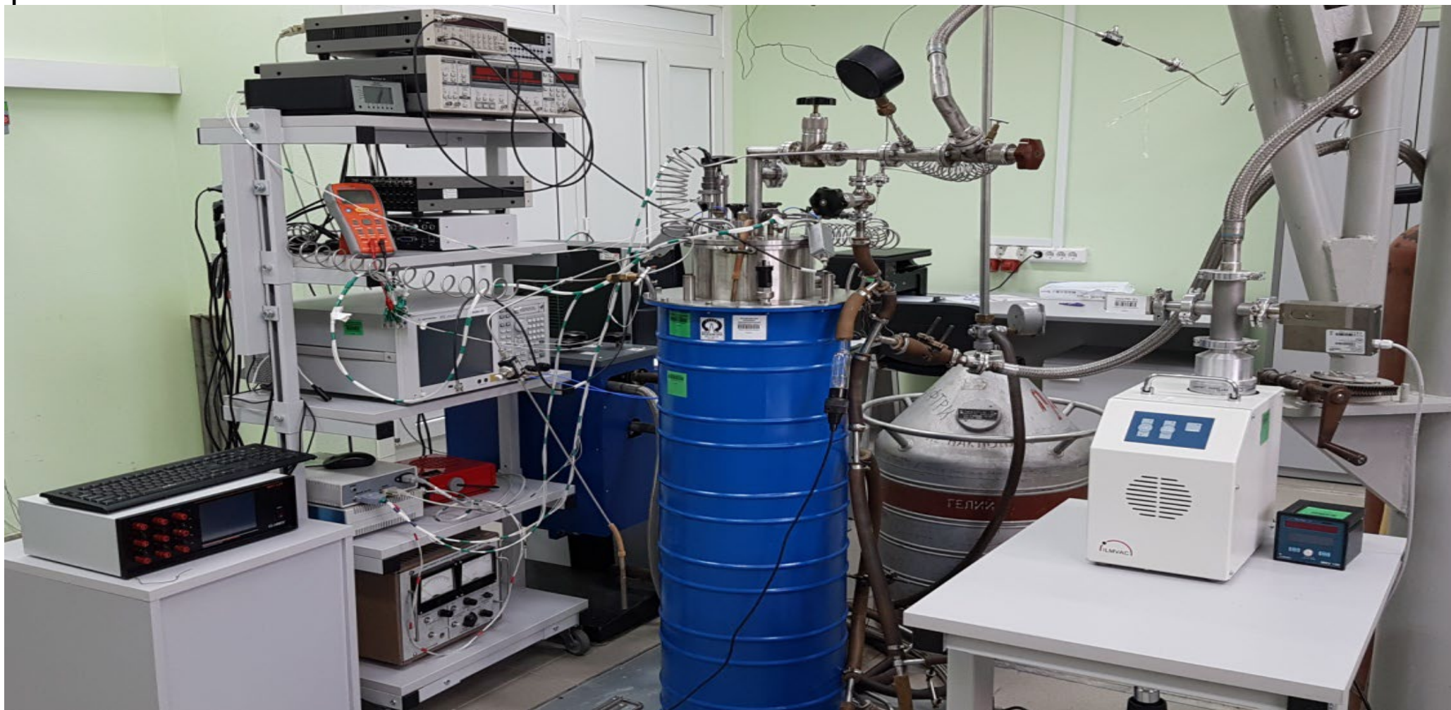
Установка для измерения акустическим методом термодинамической температуры в диапазоне от 79 до 273,16 К
